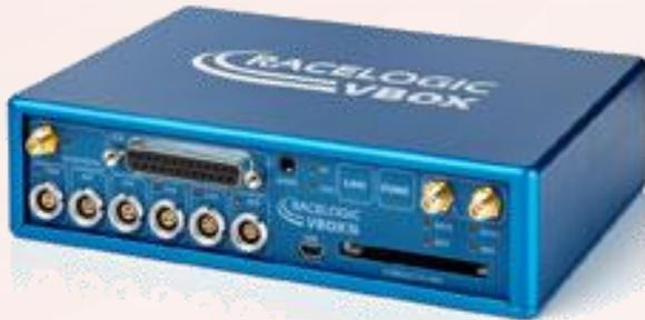
Racelogic VBox GPS (+ IMU & - DGPS).
